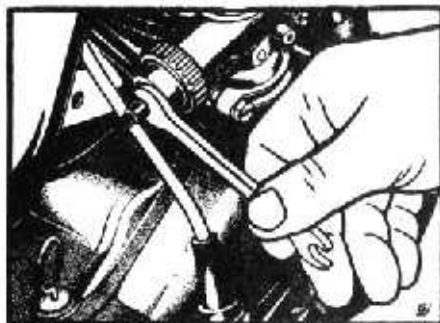
Obr. 13. Nastavenie bowdenu plynu
